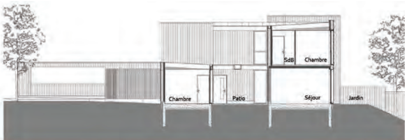
▲ Coupe transversale révélant les différentes séquences d’entrée.
