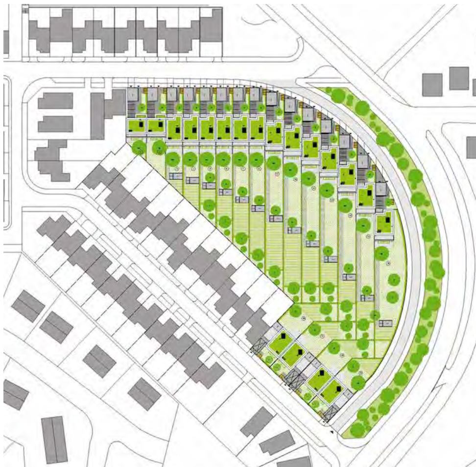
Plan-masse des 19 maisons dans la ZAC Montgaillard : les parcelles profondes se répartissent sur un plan général hémicirculaire.
